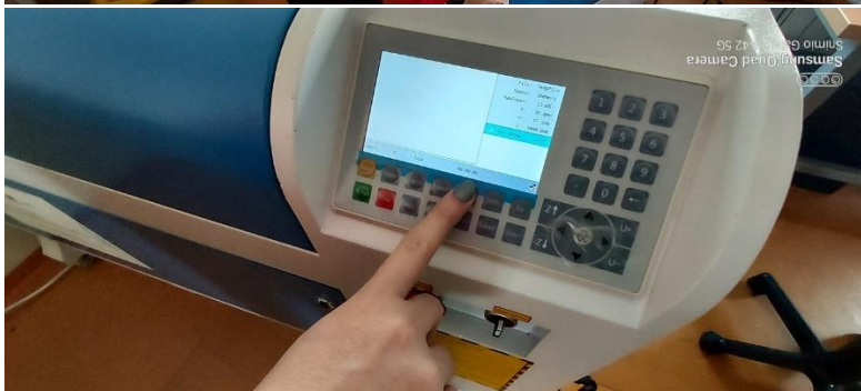
Fotografija 23 Ilustracija uključivanje CNC mašine, sigurnosni poklopac, navođenje lasera na početnu tačku rezanja.
